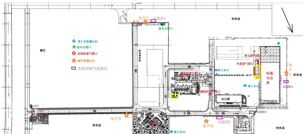
烟气在线、废水在线、噪声、无组织等监测点位示意图
